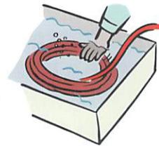
ホースは定期的に硬化したり、磨耗したり、亀裂がないか必ず点検し、ガスの漏洩事故などにならないよう、異常があればただちに新品と交換しましょう。
